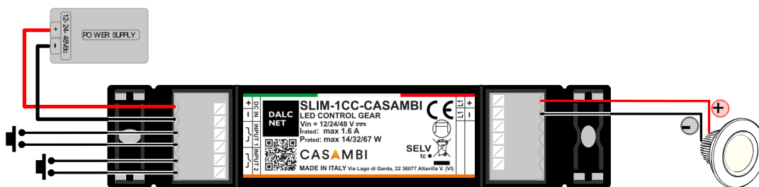
Figura 2: Schema di collegamento per carichi LED bianchi o monocolore
