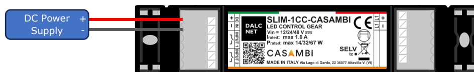
Figura 5: Schema di collegamento dell'alimentazione
